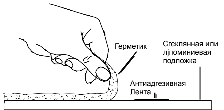
Тест на адгезию и отрыв: адгезивный отрыв
